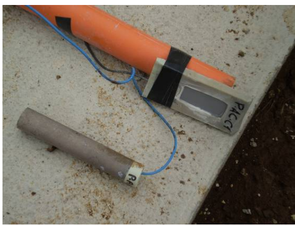
Collegamento del provino al tubo di Luggin
