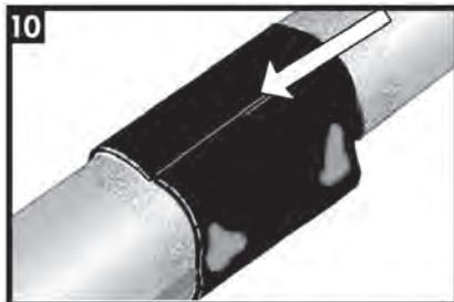
10 Infilare il manicotto sull'area del giunto in acciaio, posizionando la linea di saldatura in una posizione a ore 12 (se possibile). Posizionare il manicotto al centro per garantire minimo 50 mm di sovrapposizione sul rivestimento. Rimuovere completamente la protezione interna dalla guaina prima della termorestrizione.
