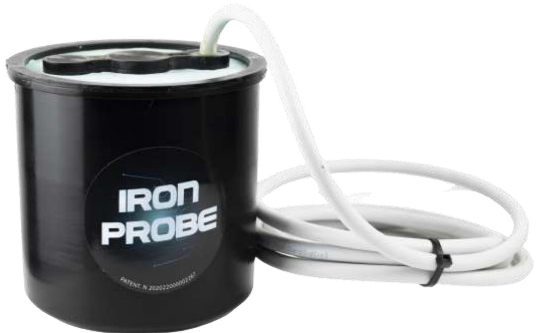
Sonda di potenziale in Rame/Solfato di Rame ( $\text{Cu}/\text{CuSO}_4$ ) in MISCELA per la misura del potenziale Eirfree in accordo alla norma UNI EN ISO 15589-1, per sistemi di Protezione Catodica. Marchio europeo registrato e brevetto n. 202022000002267
