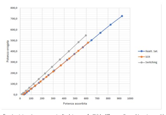
Il grafico riportato qui sopra consente di valutare con facilità la differenza di assorbimento a parità di potenza erogata. Ad esempio, se consideriamo una potenza resa di 400W possiamo vedere che la potenza assorbita è pari a 443W per il nostro alimentatore Switching LSW e di 530W per le altre due tipologie di alimentatori.
